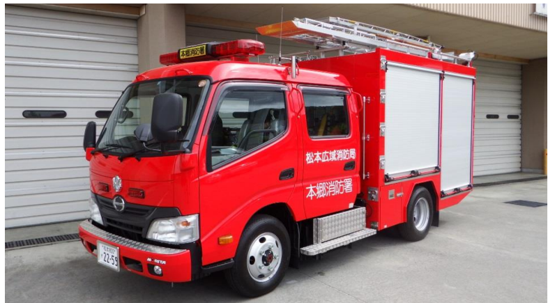
本郷消防署・明科消防署 圧縮空気泡消火装置(CAFS)付消防ポンプ自動車
